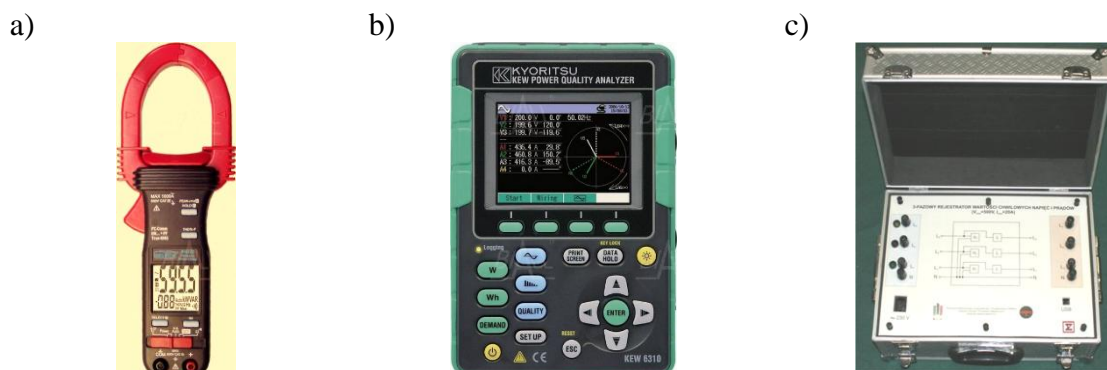
Rys. 1. Widok przyrządów pomiarowych do pomiaru poboru mocy laboratoryjnych i przemysłowych urządzeń odlewniczych zasilanych energią elektryczną: a) miernik cęgowy BM155 firmy Brymen, b) analizator jakości energii elektrycznych KEW6310 firmy Kyoritsu, c) rejestrator wartości chwilowych napięć i prądów.
