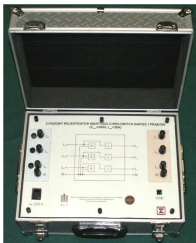
Rys. 1. Widok rejestratora wartości chwilowych napięć i prądów.
